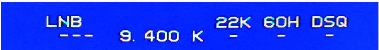
Su un altro ricevitore collegato ad un LNB non modificato sintonizzare un canale della parte alta dello spettro o attivare il tono a 22KHz e avvicinando i due LNB sul ricevitore analogico sintonizzato a 10600MHz dovrebbe sparire il fruscio della mancanza di segnale e lo schermo dovrebbe diventare completamente nero ad indicare che si sta ricevendo l'oscillatore del secondo LNB
