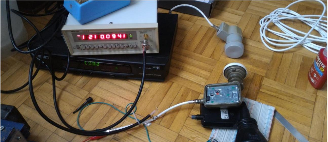
Nella foto sono chiaramente visibili i due LNB e il frequenzimetro indicante 1210MHz, una volta trovata la frequenza esatta bisogna bloccare la vite di regolazione con una goccia di frena-filetti o di smalto.
