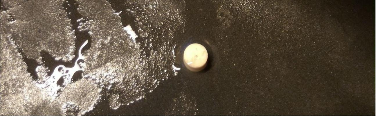
Una volta portata alla misura corretta bisogna incollare il lato limato alla vite di regolazione usando una delicatissima goccia di colla a rapida essiccazione possibilmente sul lato esterno della vite in modo che ci sia la minor quantità possibile di colla tra la vite e la pastiglia. Svitare quasi completamente la vite fino a lasciare circa un millimetro tra la pastiglia e la copertura metallica, poi richiudete il tutto.
